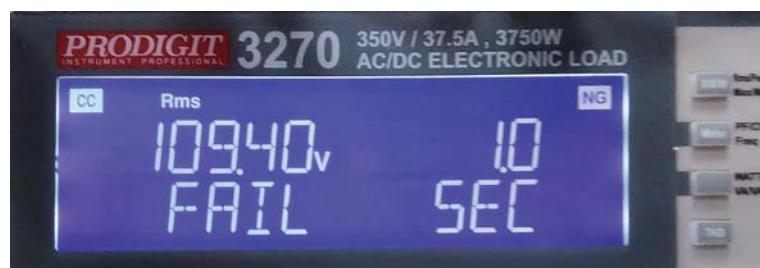
電壓 110V 循環次數設定為10次，測試時間 1秒，測試結果Fail（Trip測試結果未熔斷）
