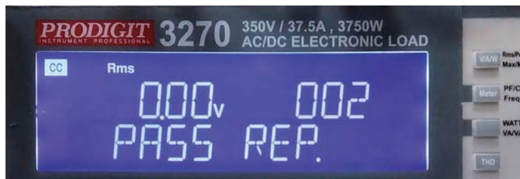
電壓 110V 循環次數設定為10次，測試結果PASS（Trip測試結果 2 次熔斷）
