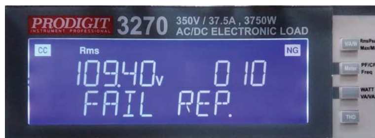
電壓 110V 循環次數設定為10次，測試結果Fail（Trip測試結果未熔斷）
