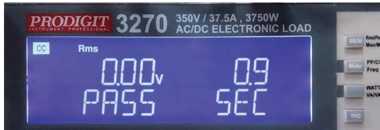
電壓 110V 循環次數設定為10次，測試時間 1秒，測試結果PASS（Trip測試結果 0.9 秒熔斷）
